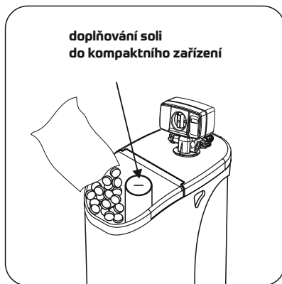
obr. 8 šachta solankového ventilu
