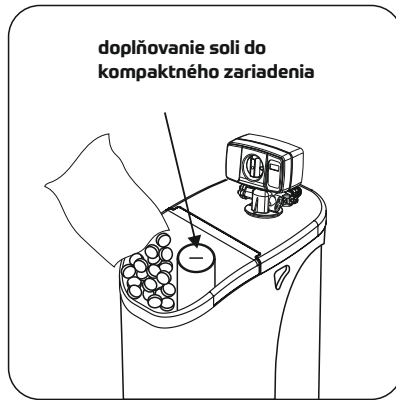
obr. 8 šachta ventilu soľanky
